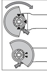
Покладіть захисний кожух (12) на кріплення на електроінструменті так, щоб кодовані кулачки захисного кожуха відповідали кріпленню. При цьому натисніть і тримайте натисненим розблокувальний важіль (1).
