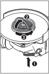
Правильно затягну, непошкоджену швидкозатискну гайку (21) можна відпустити від руки. Для цього підніміть скобу швидкозатискної гайки догори і з силою поверніть швидкозатискну гайку проти стрілки годинника. Ніколи не відкручуйте швидкозатискну гайку, яка сидить дуже міцно, за допомогою інструмента – використовуйте
