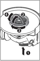
Натисніть на фіксатор шпинделя (2), щоб зафіксувати шліфувальний шпиндель. Для затягнення швидкозатискної гайки (21) підніміть скобу швидкозатискної гайки догори і з силою поверніть швидкозатискну гайку за стрілкою годинника. Опустіть скобу для фіксації швидкозатискної гайки. **Затискання за обід диска не є достатнім.**
