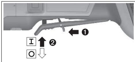
Щоб **увімкнути** електроінструмент, посуньте важіль розблокування (4) уперед і притисніть після цього вимикач (3) угору.
