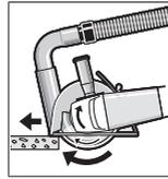
Увімкніть електроінструмент і приставте його передньою частиною напрямних салазок до оброблюваної заготовки. Просувайте електроінструмент із помірною подачею у відповідності до оброблюваного матеріалу.
