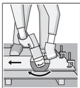
Всегда ведите электроинструмент против направления вращения. В противном случае существует опасность неконтролируемого вырывания инструмента из прорези. При резке профилей или четырехгранных труб начинайте рез на наименьшем поперечном сечении.
