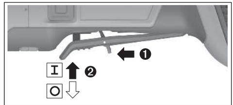
За въвеждане в експлоатация на електроинструмента избутайте лоста за отключване (4) напред и натиснете след това превключвателя за вкл./изкл (3) нагоре.
