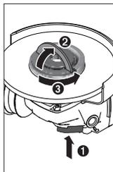
Правилно затегнатата и неповредена бързообтяжна гайка (21) може да се развие на ръка. За целта повдигнете скобата на бързообтяжната гайка и силно завъртете бързообтяжната гайка обратно на часовника. В никакъв случай не опитвайте да развие с инструмент, за целта използвайте ключ с два отвора.
