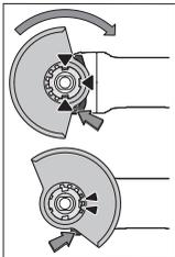
Поставете предпазния кожух (12) на захващащото стъпало на електроинструмента така, че кодиращите гърбици да съвпадат с каналите на стъпалото. При това натиснете и задържете освобождаващия лост (1). Притиснете предпазния кожух (12) към шийката на електроинструмента, докато борта на предпазния кожух допре до фланеца на електроинструмента и завъртете предпазния
