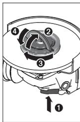
Натиснете бутона за фиксиране на вала (2), за да фиксирате вала за шлифоване. За да затегнете бързообтяжната гайка (21), вдигнете скобата на бързообтяжната гайка и завъртете силно бързообтяжната гайка по часовника. Свалете скобата за фиксиране на бързообтяжната гайка. **Затягане по ръба на диска не е достатъчно.**
