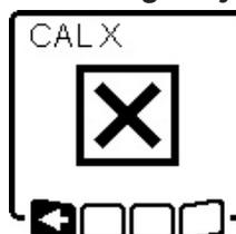
Hvis kalibreringen av X- eller Y-aksen mislyktes, vises en feilmelding på displayet til måleverktøyet. På displayet til lasermottakeren vises **ERR**.
