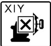
Hvis det ikke var mulig å stille inn laserstrålen på lasermottakerens senterlinje, stoppes rotasjonen av laserstrålen, og en feilmelding vises på displayet.
