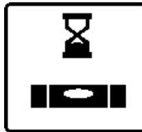
Nivelleringen begynner automatisk, og den vises av det blinkende symbolet for nivellering på displayet, de blinkende laserstrålene og den grønne, blinkende statusindikatoren (12) (se „Automatisk nivellering“, Side 15).
