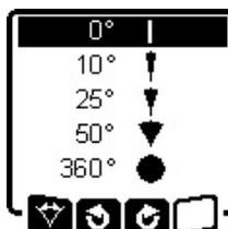
» For å endre åpningsvinkelen, trykk på knappen på måleverktøyet eller på fjernkontrollen til ønsket driftsmodus vises på displayet.
