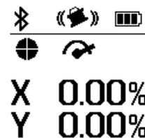
Etter fullført nivellering vises startskjermen, laserstrålene lyser kontinuerlig, rotasjonen starter og statusindikatoren (12) lyser kontinuerlig grønt.
