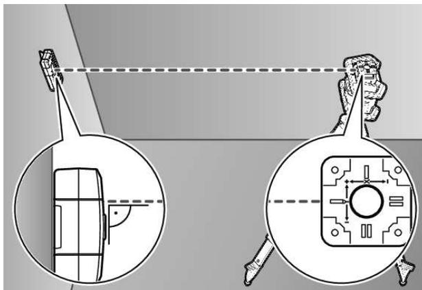
» Sett rotasjonslaseren og lasermottakeren slik at lasermottakeren befinner seg i retning X-aksen eller Y-aksen til rotasjonslaseren.
