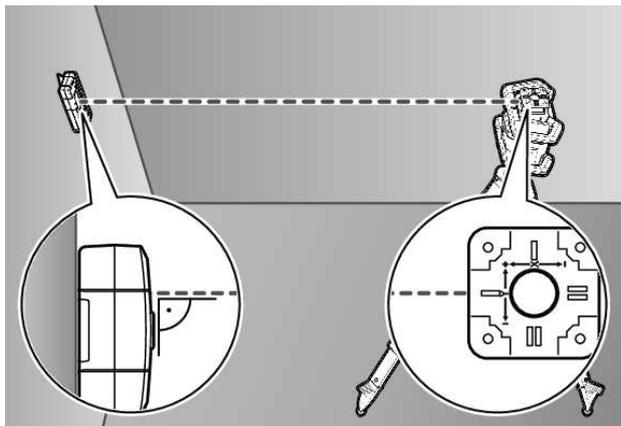
» Sett rotasjonslaseren og lasermottakeren slik at lasermottakeren befinner seg i retning X-aksen eller Y-aksen til rotasjonslaseren.
