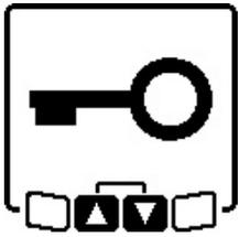
Tastaturet til måleverktøyet og fjernkontrollen kan låses via **Bosch Levelling Remote App**. Symbolet for tastelås vises på displayet til måleverktøyet.
