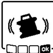
Hvis posisjonen til måleverktøyet endres eller det oppdages et kraftig sjokk, utløses sjokkvarselet. Laserens rotasjon stopper og en feilmelding vises. Statusindikatoren **(12)** blinker raskt rødt, og et varselsignal med rask lydsekvens utløses.
