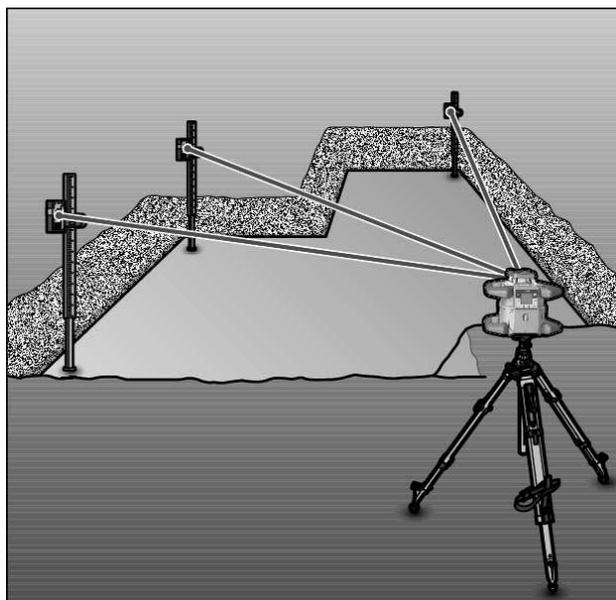
Til kontroll av om flaten er plan eller markering av helninger anbefales det å bruke nivellerstangen **(42)** sammen med lasermottakeren.
