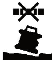
Hvis måleverktøyet står mer enn 8,5 % skrått eller er plassert i en annen stilling enn horisontal eller vertikal, er det ikke mulig å nivellere. En feilmelding vises på displayet, og statusindikatoren **(12)** blinker rødt.
