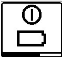
Hvis det oppladbare batteriet eller engangsbatteriene er tomme, vises en varselmelding i noen sekunder, og statusindikatoren (12) blinker raskt rødt. Deretter slås måleverktøyet av.
