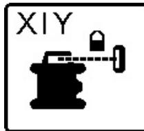
Under søket vises symbolet for CenterLock én eller begge akser på displayet til måleverktøyet, og statusindikatoren **(12)** blinker rødt.
