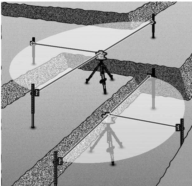
I rotasjonsmodus kan du slå av den variable laserstrålen (8) for én eller flere kvadranter i rotasjonsplanet. Dermed er det mulig å begrense faren forbundet med laserstråling, til bestemte områder. Dessuten er det mulig å unngå forstyrrelser på annet utstyr på grunn av laserstrålen eller forstyrrelse på lasermottakeren på grunn av uønsket refleksjon.
