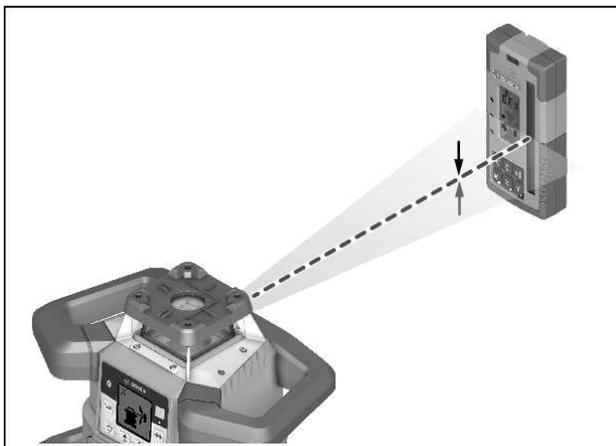
Laserstrålen kan når rotasjonslaseren er i **horisontal stilling** justeres i forhold til rotasjonslaserens X-akse, Y-aksen eller til begge aksene samtidig (se „Finne helning med CenterFind-modus“, Side 36).
