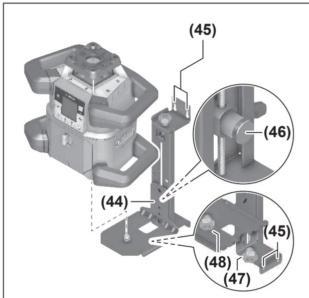
Du kan feste måleverktøyet på en vegg ved bruk av veggholderen med justeringsenhet **(44)**. Montering av veggholderen anbefales for eksempel ved arbeid som ligger over uttrekkshøyden til stativet, eller ved arbeid på ustabil underlag og uten stativ.
