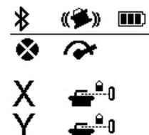
Hvis laserstrålen på senterlinjen til lasermottakeren justeres, vises symbolet CenterLock på startskjermbildet for én eller begge aksene. Helningsverdiene vises ikke.
