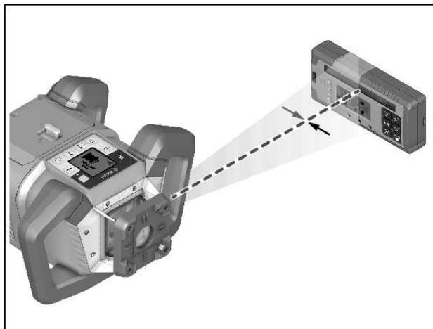
Når rotasjonslaseren er i **vertikal stilling**, er bare justering i forhold til Y-aksen mulig.
