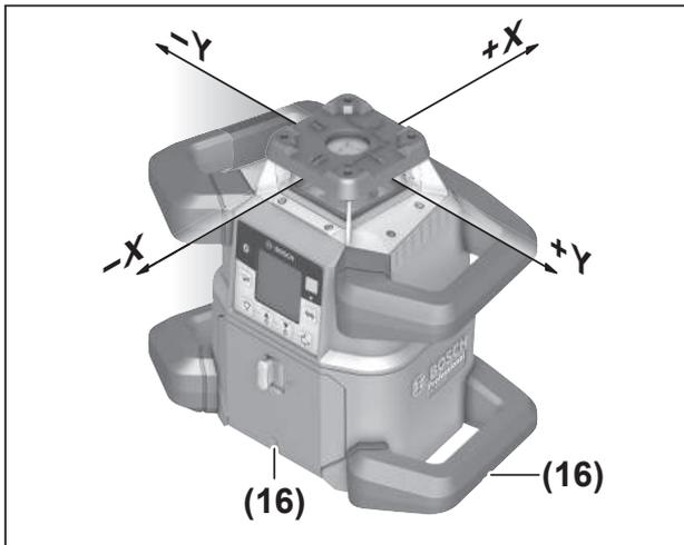
X- og Y-aksens innstilling er markert over rotasjonshodet på huset. Merkene er nøyaktig over hakkene for innstilling (16) på kanten nede på huset og på det nedre håndtaket. Ved hjelp av hakkene for innstilling kan du stille inn måleverktøyet langs aksene.
