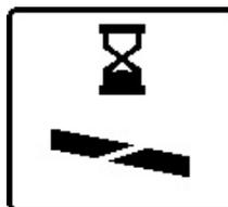
Den valgte helningen brukes på måleverktøyet noen sekunder etter det siste knappetrykket. Laserstrålen og symbolet for helningsinnstilling på displayet blinker helt til helningsinnstillingen er avsluttet.
