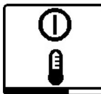
Hvis maksimalt tillatt driftstemperatur på 50 °C overskrides, vises en varselmelding i noen sekunder, og statusindikatoren (12) blinker rødt.
