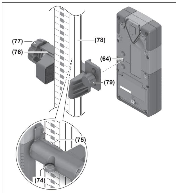
Med holderen (76) kan du feste lasermottakeren både på en nivellerstang (78) og feste den med andre hjelpemidler med en bredde på opptil 65 mm.
