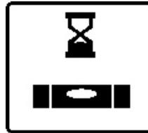
Under nivelleringen blinker symbolet for nivelleringen på displayet. Samtidig blinker statusindikatoren **(12)** på måleverktøyet og statusindikatoren for den gjeldende aksene **((33)** eller **(34))** på fjernkontrollen grønt.
