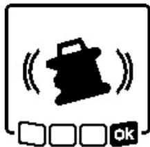
Si se cambia la posición del instrumento de medición o se registra una sacudida fuerte, se activa la advertencia de impacto. La rotación del láser se detiene y aparece un mensaje de error. La indicación de estado **(12)** parpadea rápidamente en rojo y suena una señal
