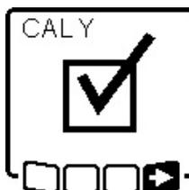
Si ha concluido correctamente la calibración del eje Y, aparecerá este símbolo en la pantalla del instrumento de medición.
