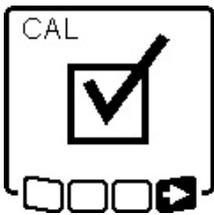
Este símbolo confirma que la calibración del eje X y del eje Y se ha efectuado correctamente con la precisión de nivelación seleccionada al principio.
