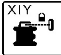
Durante la búsqueda, en la pantalla del instrumento de medición aparece el símbolo de CenterLock para uno o ambos ejes, y la indicación de estado (12) parpadea en rojo.
