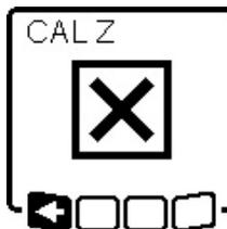
Si la calibración del eje Z ha fallado, aparece este mensaje de error.
