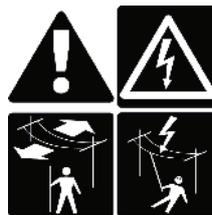
**En el caso de trabajos con la regla de nivelación en las cercanías de cables de alta tensión, debe prestarse especial precaución.** Si la regla de nivelación se acerca a líneas de alta tensión, puede producirse una descarga eléctrica que puede causar la muerte.
