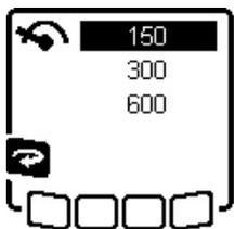
» Para cambiar la velocidad de rotación, pulse repetidamente la tecla
