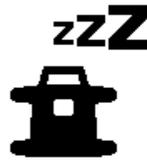
Cuando el modo en reposo está activado, en la pantalla se muestra el símbolo de modo en reposo. La indicación de estado (12) parpadea a ritmo lento en verde. La función de advertencia de impacto permanece activa, todos los ajustes se guardan.
