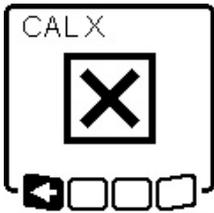
Si ha fallado la calibración del eje X o Y, aparecerá el mensaje de error correspondiente en la pantalla del instrumento de medición. En la pantalla del receptor láser se muestra **ERR**.
