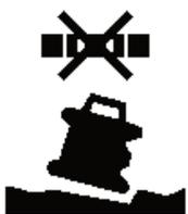
Si el instrumento de medición tiene una inclinación superior al 8,5 % o está posicionado de forma diferente a la posición horizontal o vertical, ya no es posible nivelarlo. En este caso, aparece un mensaje de error en la pantalla y la indicación de estado **(12)** parpadea
