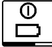
Si el acumulador o las pilas están agotados, aparece un mensaje de advertencia durante unos segundos y la indicación de estado (12) parpadea en rojo a intervalos rápidos. A continuación, se desconecta el instrumento de medición.
