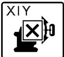
Si no ha sido posible alinear el rayo láser a la línea central del receptor láser, se detiene la rotación del rayo láser y en la pantalla aparece un mensaje de error.
