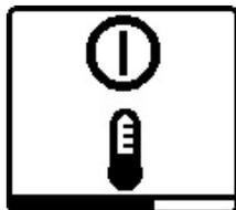
Si se supera la temperatura de servicio máxima permitida de 50 °C, durante unos segundos aparece un mensaje de advertencia y la indicación de estado (12) parpadea en rojo.
