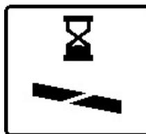
Unos segundos después de la última pulsación de la tecla, la inclinación seleccionada en el instrumento de medición cambia. El rayo láser y el símbolo de ajuste de la inclinación de la pantalla parpadean hasta que se completa el
