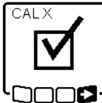
Si ha concluido correctamente la calibración del eje X, aparecerá este símbolo en la pantalla del instrumento de medición.
