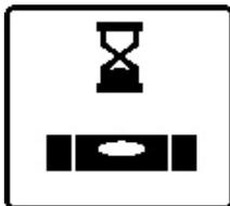
حتى نهاية التسوية يكون التدوير متوقفاً وتومض أشعة الليزر. بعد انتهاء التسوية بنجاح تظهر الشاشة الرئيسية. تضيء أشعة الليزر باستمرار ويبدأ الدوران. يضيء بيان الحالة (12) بعدة القياس بالإضافة إلى بيان حالة المحور الذي تمت تسويته ((33) أو ((34) بجهاز التشغيل عن بعد باستمرار باللون الأخضر.
